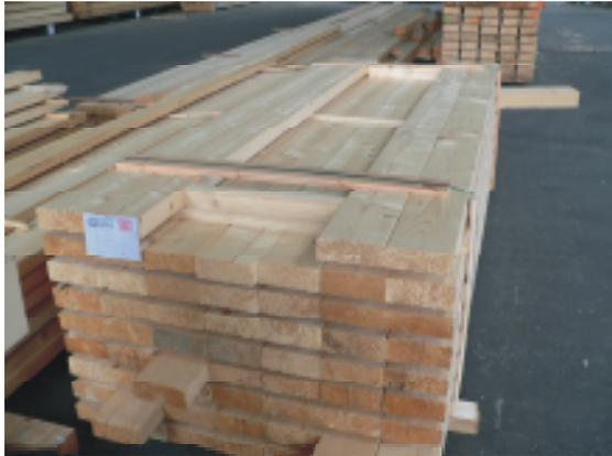
Verwendet wurde kammergetrocknetes, gehobeltes Schnittholz, das nach den mit dem Abbundprogramm erstellten Plänen vollautomatisch und maschinell millimetergenau zugeschnitten wurde.
